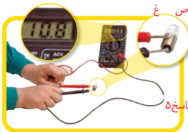
شکل ۸- اندازه گیری مقاومت لامپ خاموش با اهم سنج
