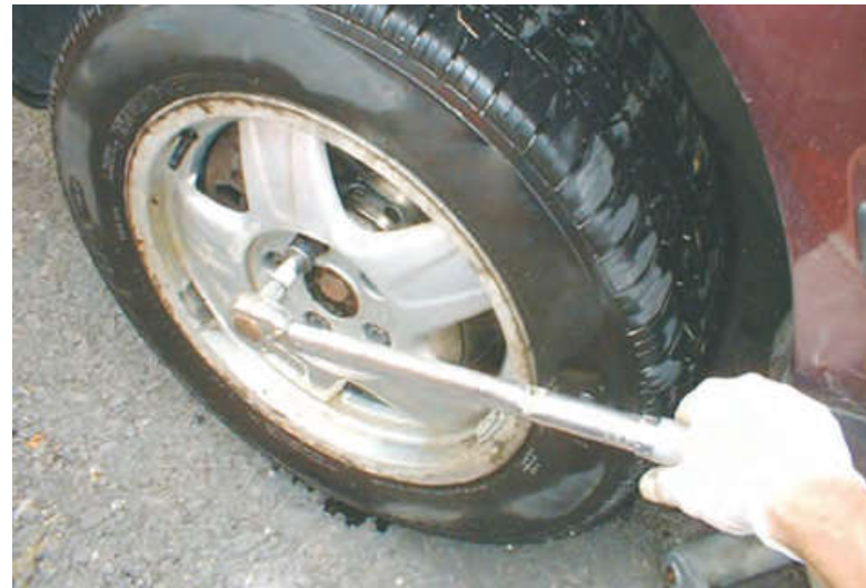
شکل ۶- با وارد کردن نیرو به دسته آچار، پیچ می‌چرخد.
